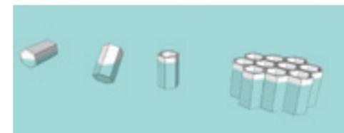
ハニカム単体の内部に注水してバランスをとりながら建て起こし。ハニカム同士は、接合面をゴムガスケットで四角く囲み、壁間の水を抜く水圧接合を採用。接合面緊結のため、さらに高強度コンクリート+スタッドによる二次接合化。
