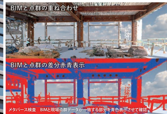
メタバース検査 BIMと現場点群データが一致する部分を青色表示させて確認
