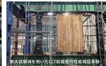
実大試験体を用いたCLT耐震壁の性能検証実験
