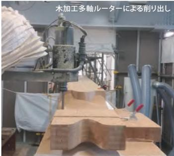
木加工多軸ルーターによる削り出し
