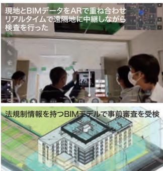
現地とBIMデータをARで重ね合わせリアルタイムで遠隔地に中継しながら検査を行った
