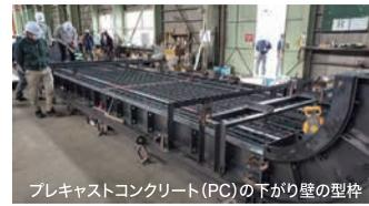
プレキャストコンクリート(PC)の下がり壁の型枠
