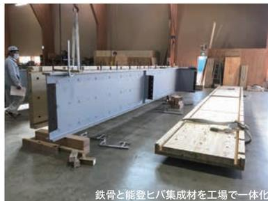
鉄骨と能登ヒバ集成材を工場で一体化
