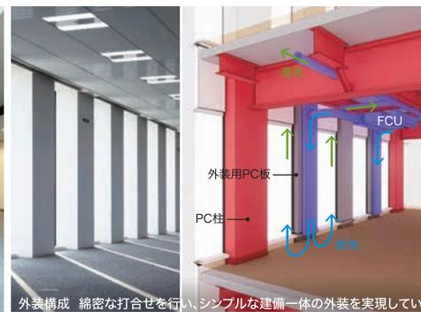
外装構成 綿密な打合せを行い、シンプルな建備一体の外装を実現している
