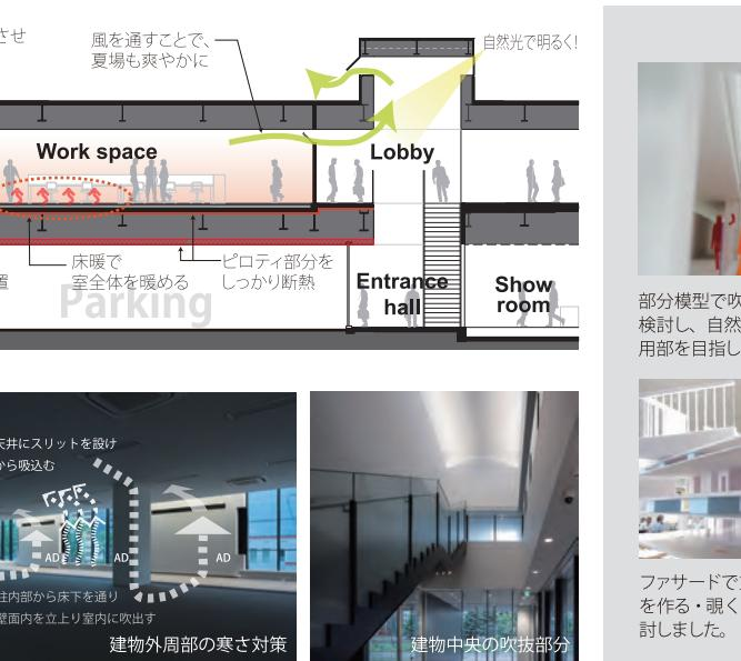
効率的な暖房とし、断熱によって、冬も暖かく快適なオフィスとしています。主要諸室には床暖房による居住暖房をとり入れ、大きなガラス面を持つ建物外周部では空気の循環する仕組みをつくることで室内への寒気の流入と結露の発生を防いでいます。
