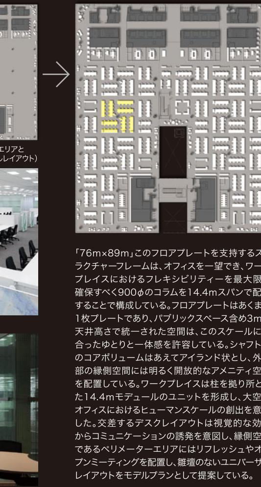
「76m×89m」このフロアプレートを支持するストラクチャーフレームは、オフィスを一望でき、ワークプレイスにおけるフレキシビリティを最大限に確保すべく900φのコラムを14.4mスパンで配置することで構成している。フロアプレートはあくまで1枚プレートであり、パブリックスペース含め3mの天井高さで統一された空間は、このスケールに見合ったゆとりと一体感を許容している。シャフト等のコアボリュームはあえてアイランド状とし、外周部の縁側空間には明るく開放的なアメニティ空間を配置している。ワークプレイスは柱を拠り所とした14.4mモジュールのユニットを形成し、大空間オフィスにおけるヒューマンスケールの創出を意図した。交差するデスクレイアウトは視覚的な効果からコミュニケーションの誘発を意図し、縁側空間であるベリメーターエリアにはリフレッシュやオープンミーティングを配置し、離壇のないユニバーサルレイアウトをモデルプランとして提案している。
