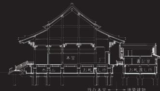
1971年に再建されたRC造の現本堂は、入母屋造鍔(シコロ)葺の壮麗な外観により、寺院の中核施設として多くの参拝客に親しまれている。今後50年、100年間建物の外観、内観を保守しながら残していくために計画された今回の改修工事の内容は、耐震性能の向上に加え、正月の混雑時対応として、1階に待合スペースを設け、お札所を増築して動線を改善する、ということの2点である。
