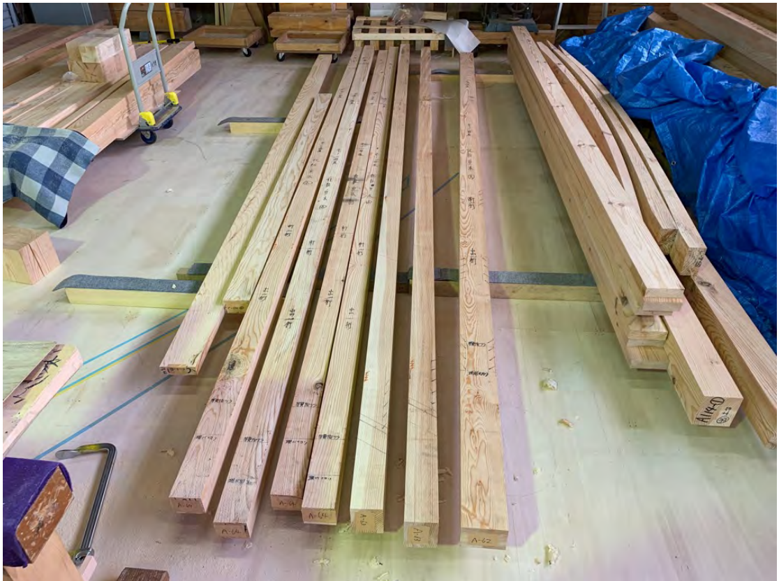
墨付け、加工を始めた木材です。【写真上:小屋組材、写真下:垂木】
