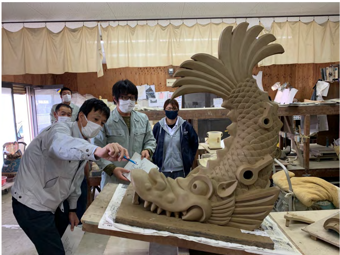
9月に半身で確認した鯪瓦粘土型を基に作成した試作品の検査を行いました。
