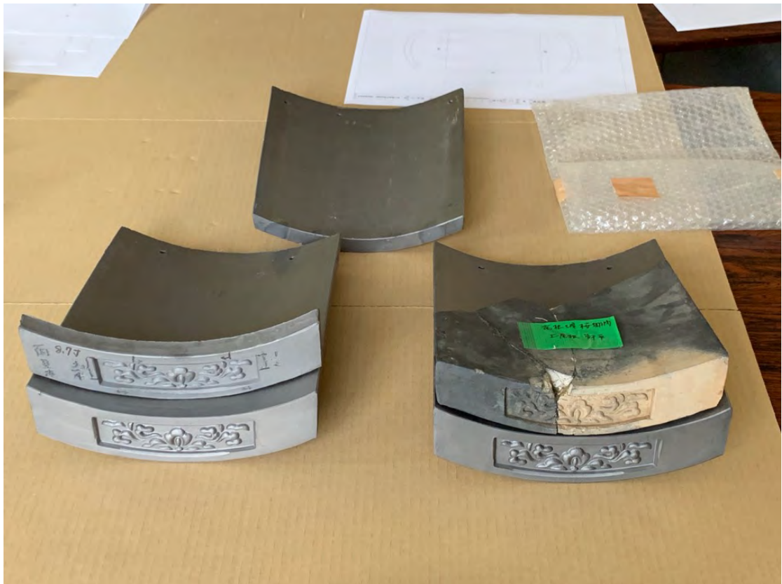
こちら9月に確認した瓦当部分を基に瓦を焼き、試作品の検査を行いました。
