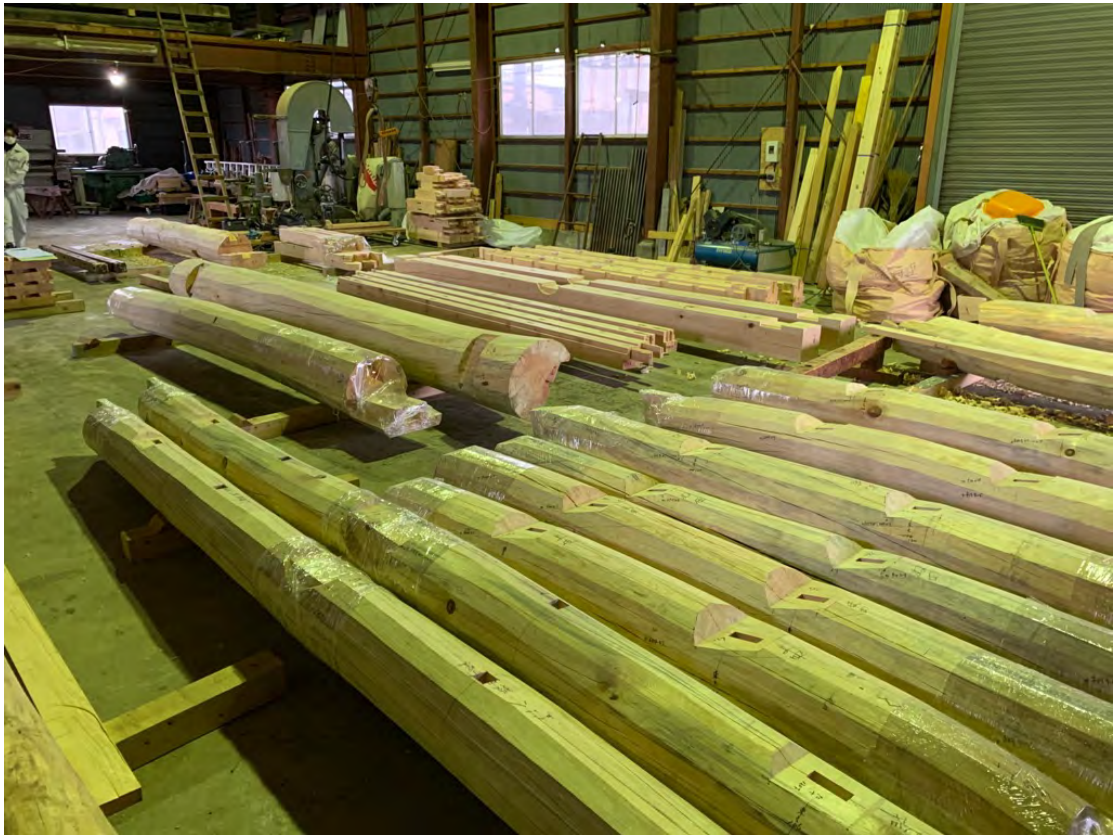
墨付け、加工を始めた木材です。【写真上:小屋組材、写真下:垂木】
