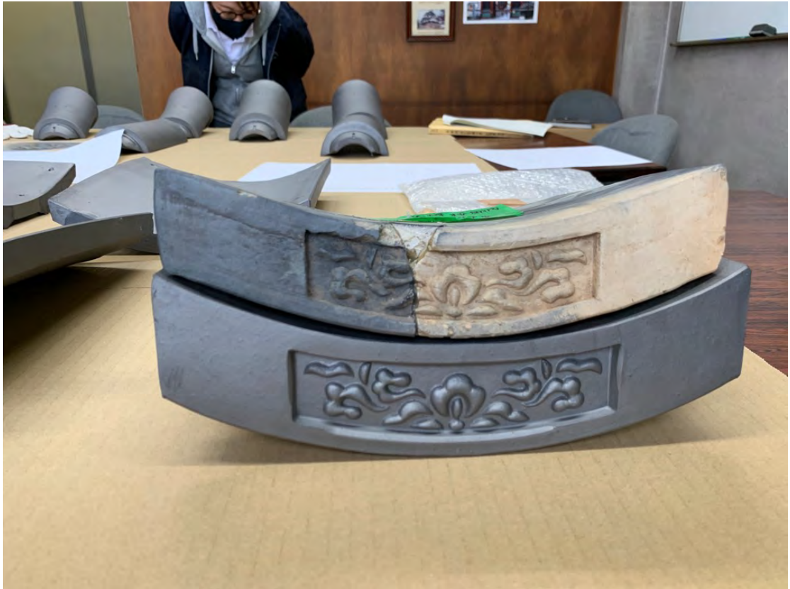
こちら9月に確認した瓦当部分を基に瓦を焼き、試作品の検査を行いました。
