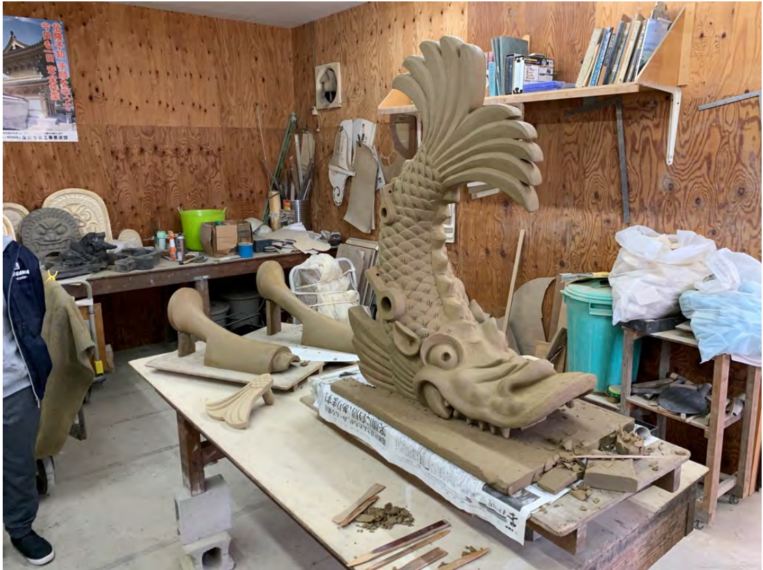
9月に半身で確認した鯪瓦粘土型を基に作成した試作品の検査を行いました。
