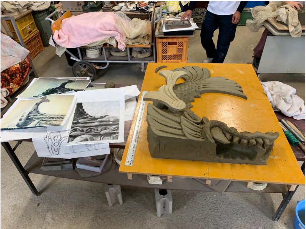
古写真より復元する鯨瓦のデザインを確認するための粘土型です。
