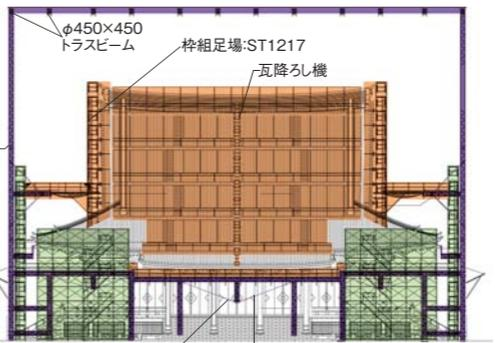
総合仮設計画図 [素屋根立面図 (A通り)]
