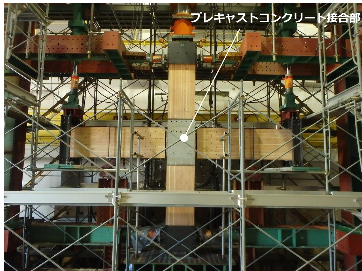
実大試験体を用いたPCa接合部の構造実験
