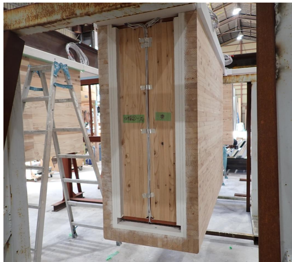
2時間耐火木鋼梁の断面（耐火試験体）
