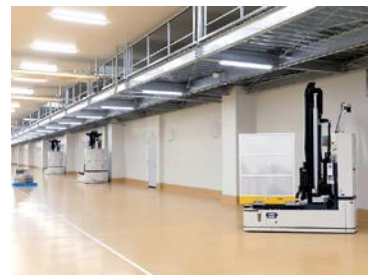
自動倉庫から生産設備に資材を供給する無人フォークリフト
