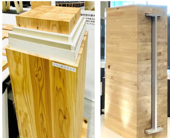
木と鉄、その他材料を組み合わせた材料ハイブリッドの耐火木部材
