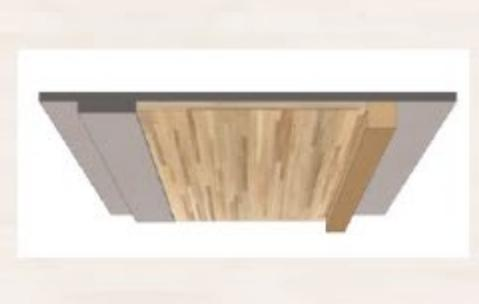
CLTをRCスラブの型枠兼化粧材とし、剛性を向上させた合成床。
