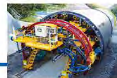
全自動施工ロボット
