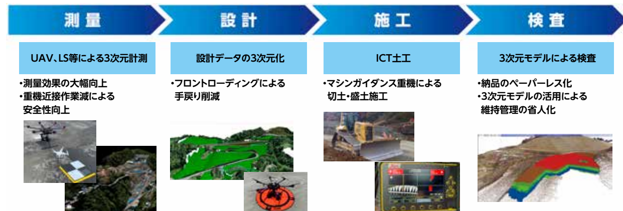
ICTフル活用工事の概要
