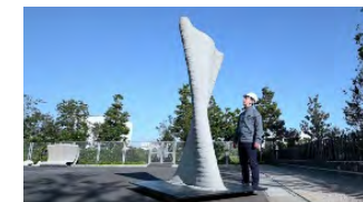
材料噴射型3Dコンクリートプリンティングシステムで造形したねじれ壁
