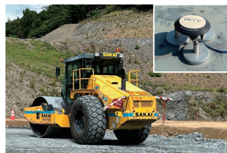
GNSS転圧ローラ
