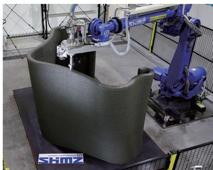
ラクツムで埋設型枠をプリント
