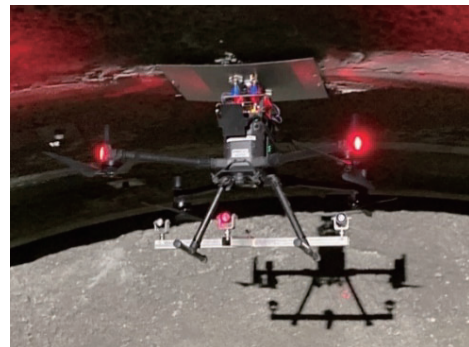
磁力を使って鋼製支保工に吸着している状況
