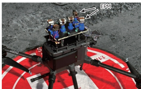
吸着EPMを6個搭載したドローン
