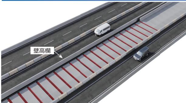
間詰めコンクリートを打ち込み、壁高欄・舗装を施工して車線を解放する準備をします。
