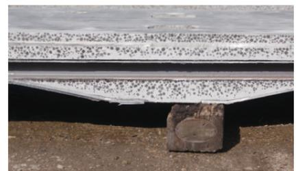
コンクリート充填確認試験
