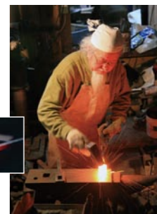
柱と長押の仕口には鍛冶・白鷹氏が鍛えた和釘を使用します。
