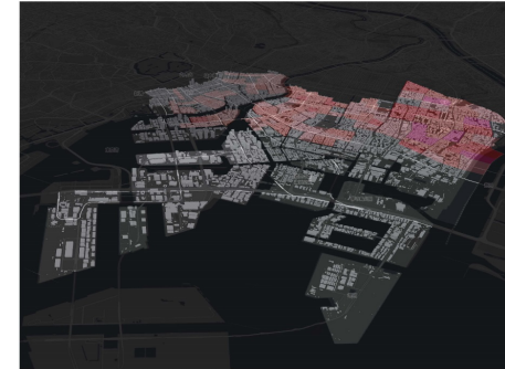
【資料A-I】:首都直下地震時・総合危険度(建物倒壊・火災被害) (出典:東京都警備局「あなたのまちの地域危険度」令和4年9月)
