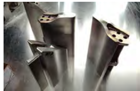
ガラスボックスフレーム材モックアップ Mockup of glass box frame member
