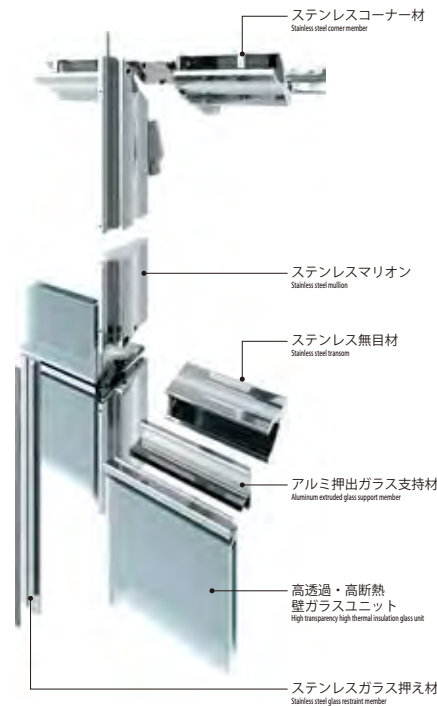
ガラスボックスフレーム分解図 Exploded view of glass box frame
