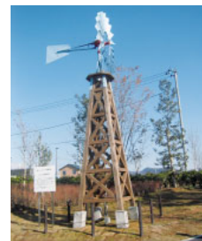
風力による地下水揚水装置
